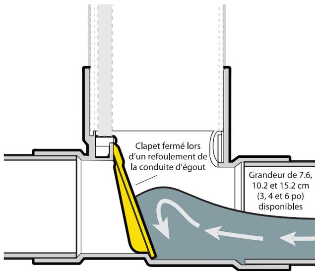
La pente minimale du Straight-Fit<sup>MC</sup> permet son installation sur les nouveaux systèmes ou pour les rénovations d'anciens systèmes.
